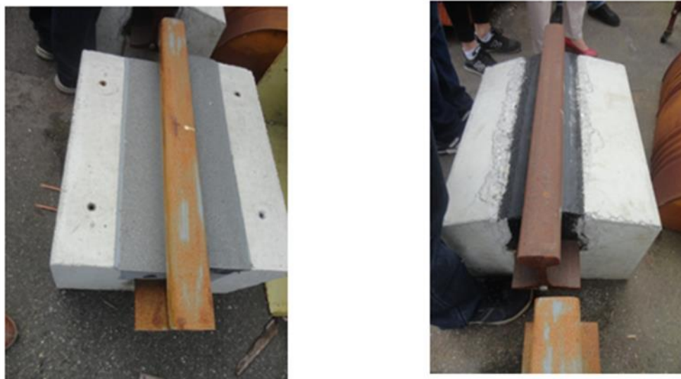
Рис. 1.10. Конструкции безбалластного пути с обрезиненным рельсом: a — элемент для трамвайных путей; b — элемент для железных дорог с преимущественно пассажирским движением
