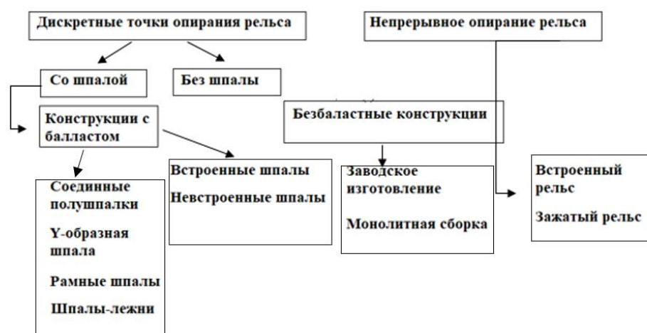
Рис. 1.6. Классификация конструкций верхнего строения пути
