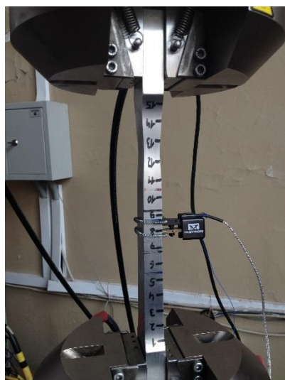
Рис. 2.13 Измерение деформаций индукционным тензодатчиком.
