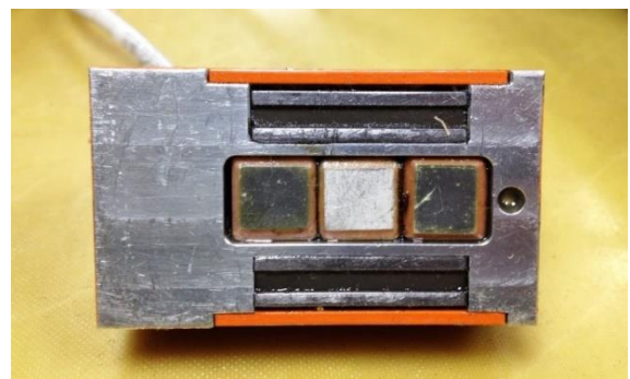
Рис. 2.3 Расположение пьезоэлектрических блоков датчика.
