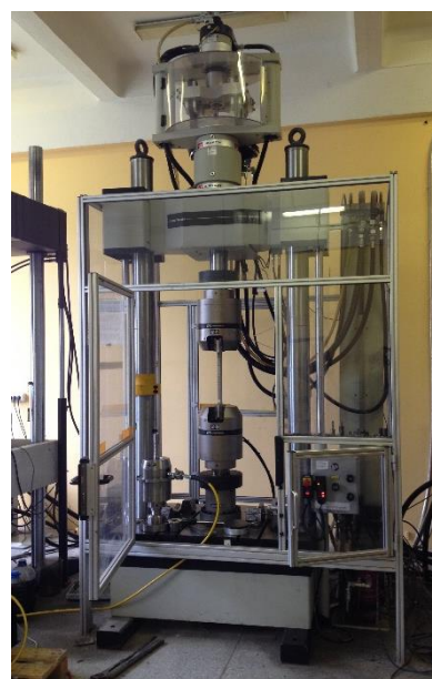
Рис. 2.10 Машина для циклических испытаний INSTRON-8850.
