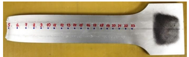
Рис. 2.43 Образец 2-№2 после разрушения.
