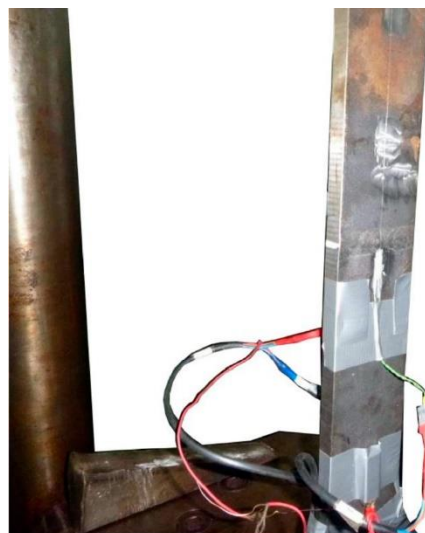
Рис. 2.12 Стальной образец в универсальной испытательной машине ЦДМ-200.
