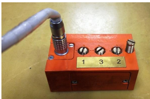
Рис. 2.2 Приемопередающий датчик с регулировочными винтами.
