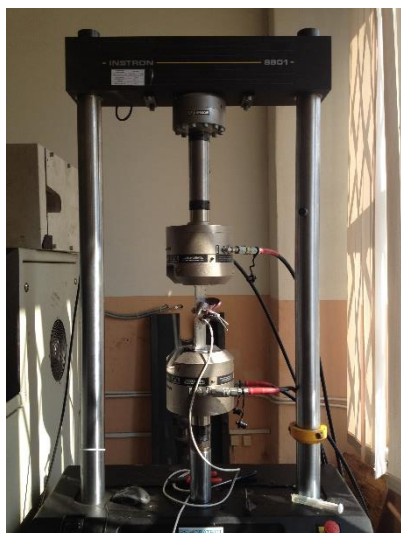
Рис. 2.11 Испытательная машина INSTRON-8801.
