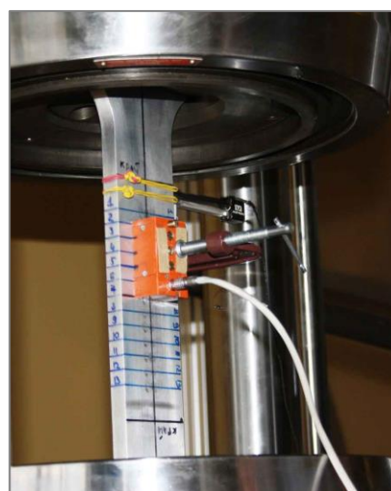
Рис. 2.14 Ультразвуковые измерения в образце под нагрузкой.
