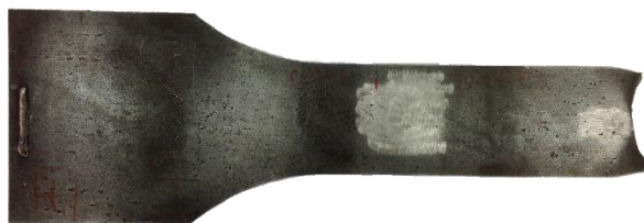
Рис. 2.7 Стальной образец марки 14ХГНДЦ.
