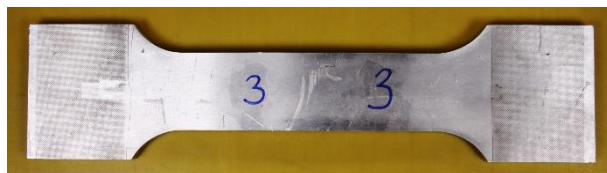
Рис. 2.17 Образец 3 партии №1 до испытаний
