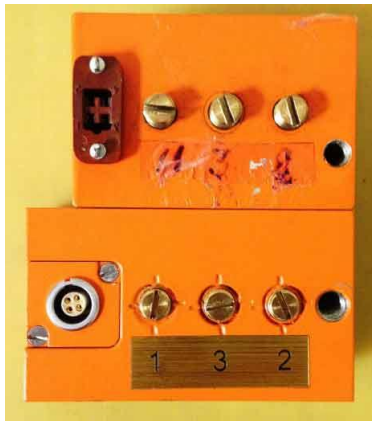
Рис. 2.46 Основной датчик 5 МГц и вспомогательный датчик 6 МГц (вид сверху)
