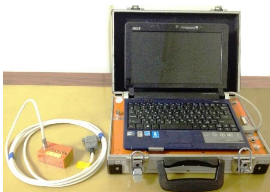
Рис. 2.1 Ультразвуковой прибор для измерения напряжений на основании данных об акустической анизотропии ИН-5101А.
