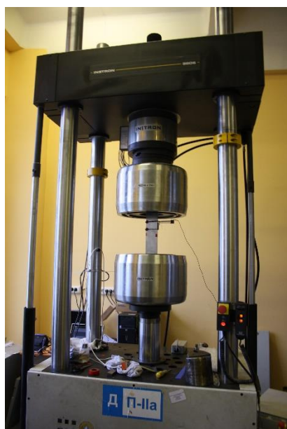
Рис. 2.9 Гидравлическая разрывная машина INSTRON-8806.
