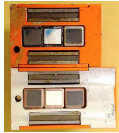
Рис. 2.47 Основной датчик 5 МГц и вспомогательный датчик 6 МГц (вид снизу)
