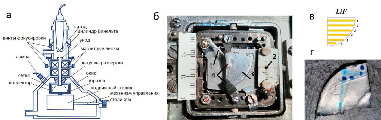
Рисунок 2.2 – а) - схема установки JEVD-2; б) - установка образцов в рабочую камеру: 1 - токоотвод, 2 - цилиндр Фарадея, 3 - образец, 4 - держатели; в) - схема ЭО малыми дозами кристалла LiF; г) - фото образца сразу после ЭО
