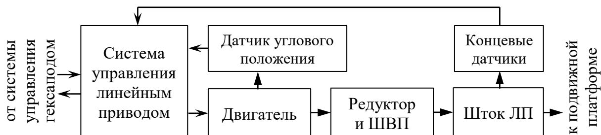
Рисунок 2.7 — Структурная схема линейного привода с косвенной обратной связью по положению
