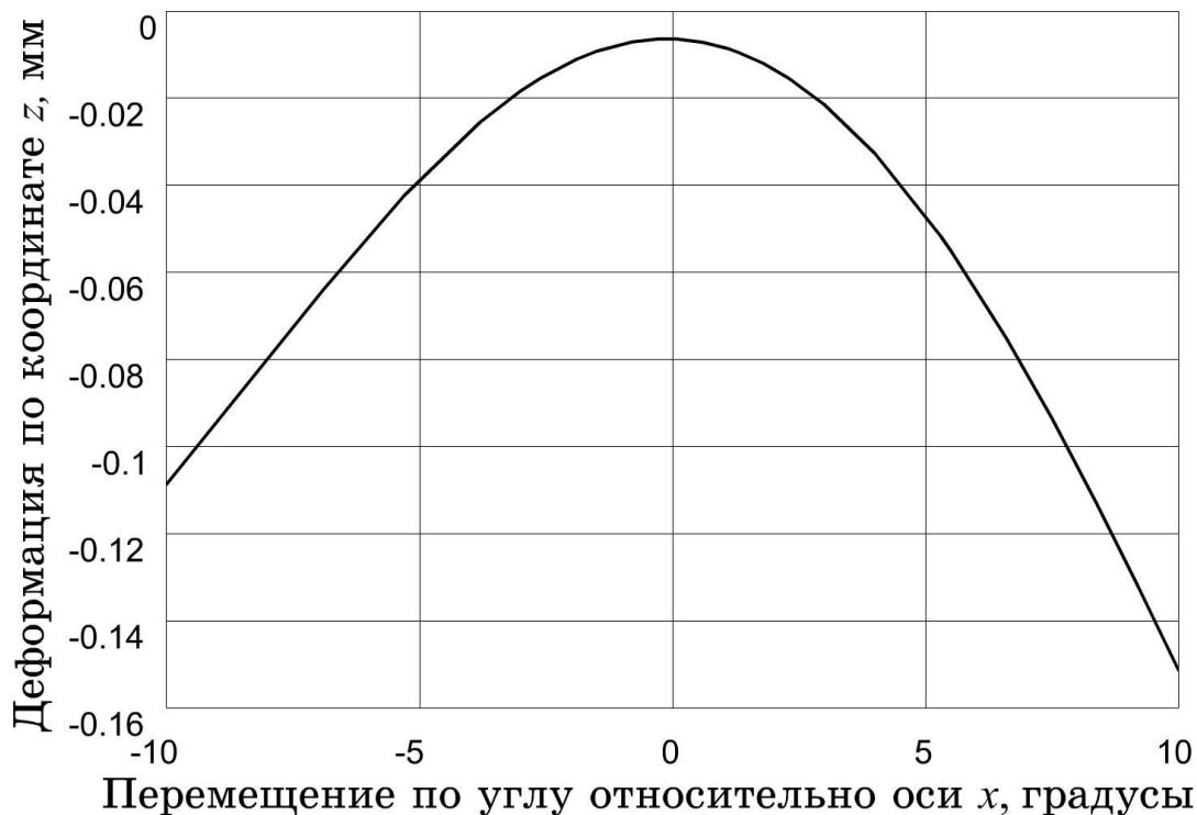
Рис. 3.4. Изменение деформации по оси z при повороте гексапода вокруг оси x при действующей силе нагрузки -25.5 Н по оси z в базовой системе координат.
