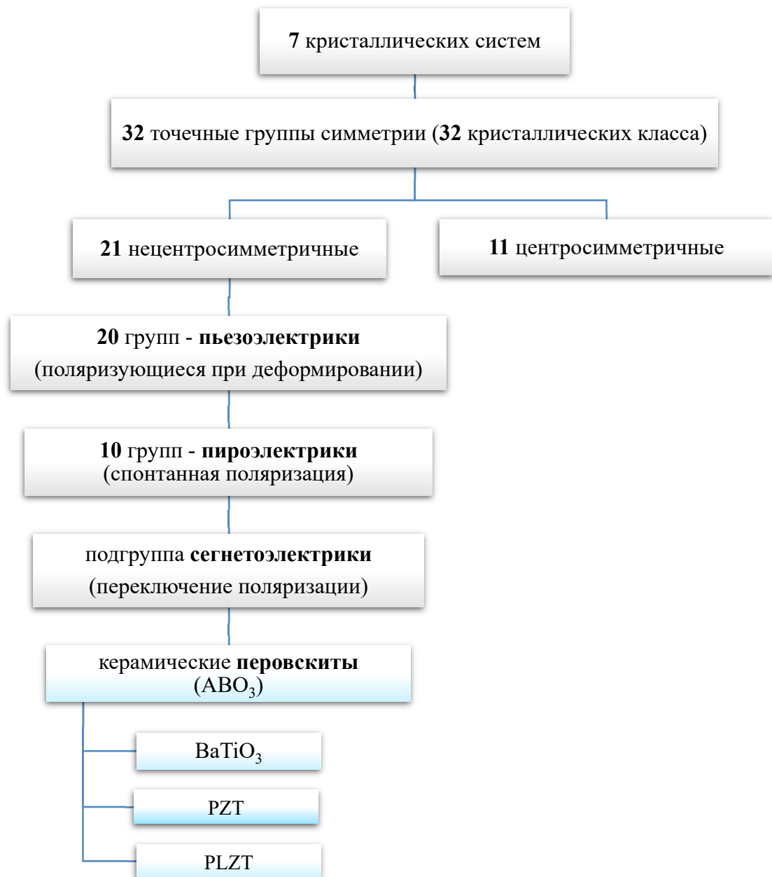
Рисунок 1.1 – Взаимосвязь между классами пьезоэлектрических, пьроэлектрических и сегнетоэлектрических кристаллов с позиции свойств симметрии [237]
