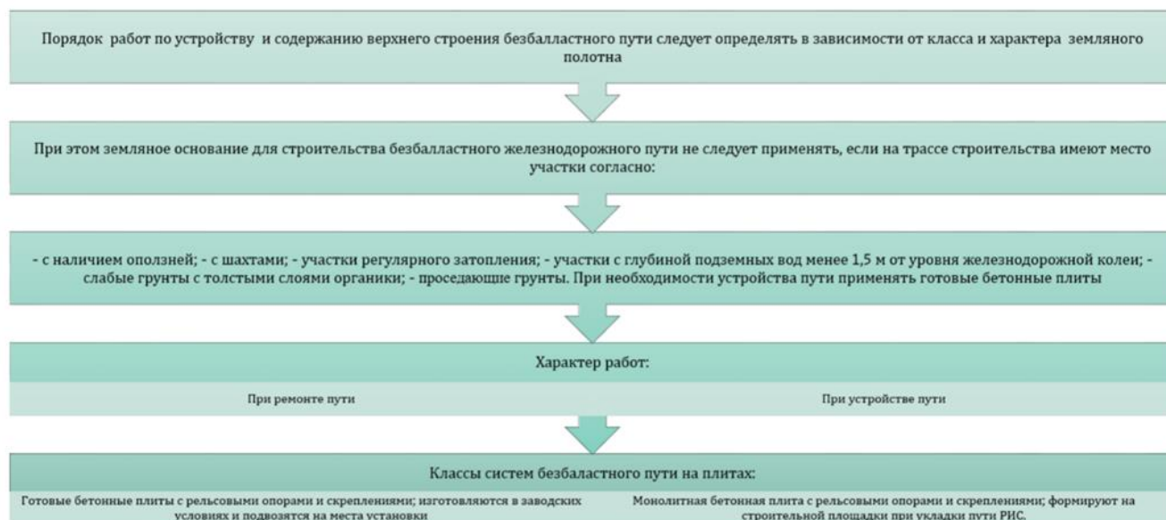
Рис. 17. Основные классы систем безбалластного пути на плитах.
