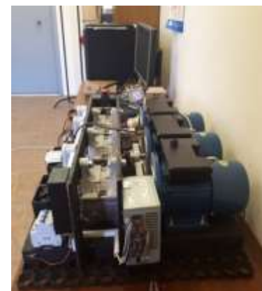
Стенд по управлению электроэнергетическими сетями
