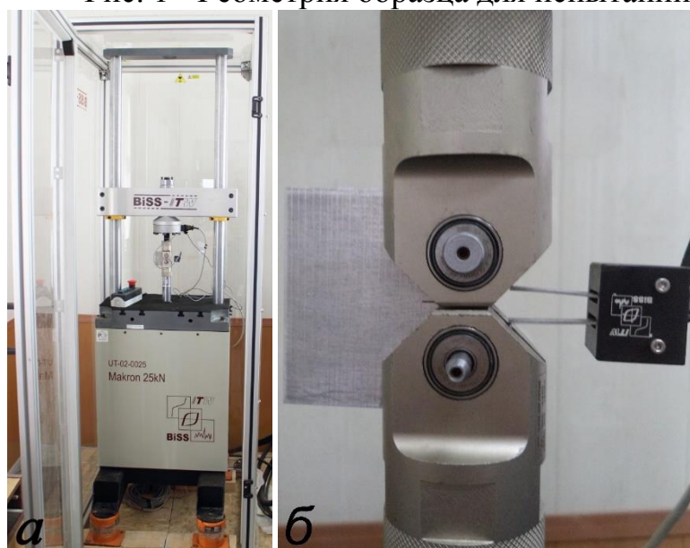
Рис. 2 - (а) Сервогидравлическая испытательная машина Makron 25 kN. (б) Хомутовые захваты с подшипниками для крепления образца
