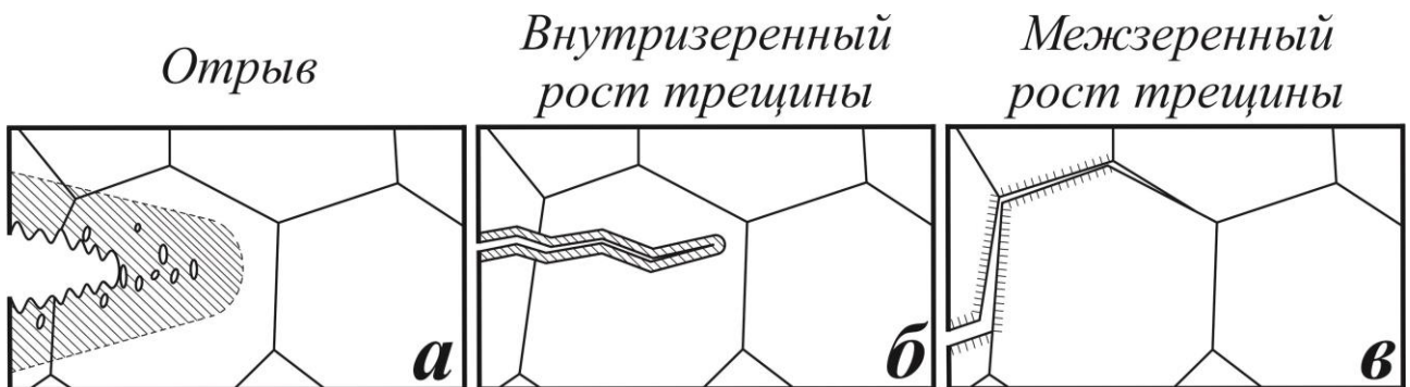
Рис. 15 – Механизмы развития усталостной трещины при водородном охрупчивании стали: а – при высоком значении КИН, б – при среднем КИН, в – при малом КИН [51]
