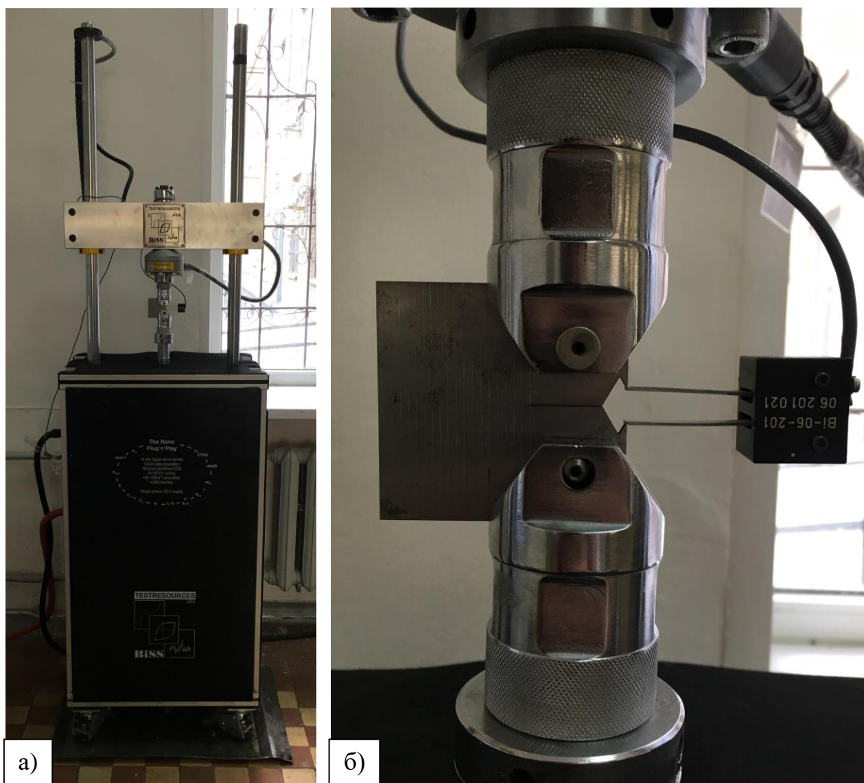
Рис. 2.4 – (а) Сервогидравлическая испытательная машина BISS Nano 25 kN (б) захваты для крепления образца и датчик раскрытия трещины
