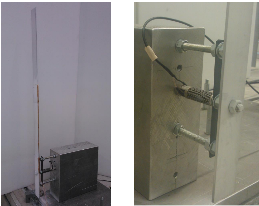
Рисунок 2.2. Закрепление балки с помощью пьезотолкателя
