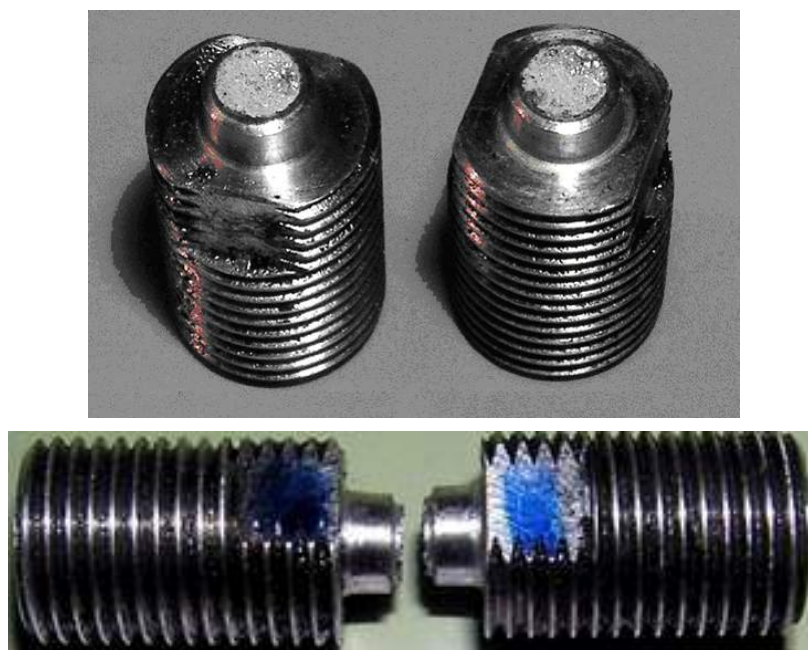
Рис. 2.53: Цилиндрический образец с V-образными вырезами.
