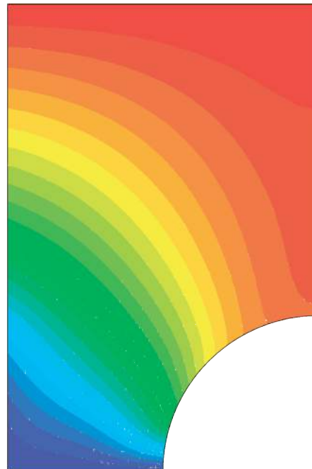
Рис. 2.44: Поле перемещений относительно осей x_1 и x_2 в момент предельного состояния.
