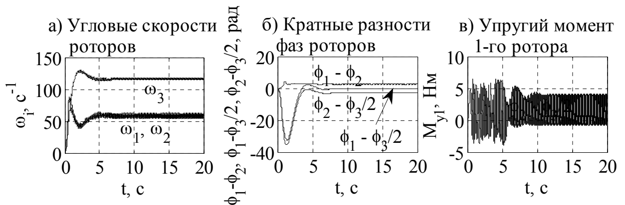
Рис. 4.28. Результаты исследования трехроторной ВУ при заданных кратностях скоростей роторов n_1 = n_2 = 1, n_3 = 2 [11]
