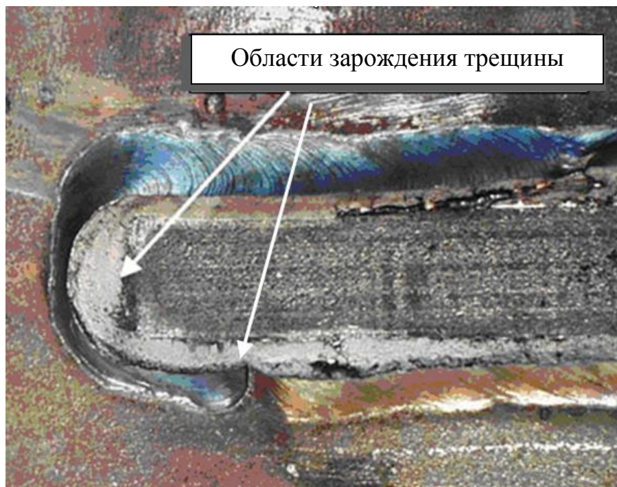
Рисунок 5.5 – Трещина в тавровом сварном соединении, образующаяся у торцевой и боковой кромки внутренней полости [81]
