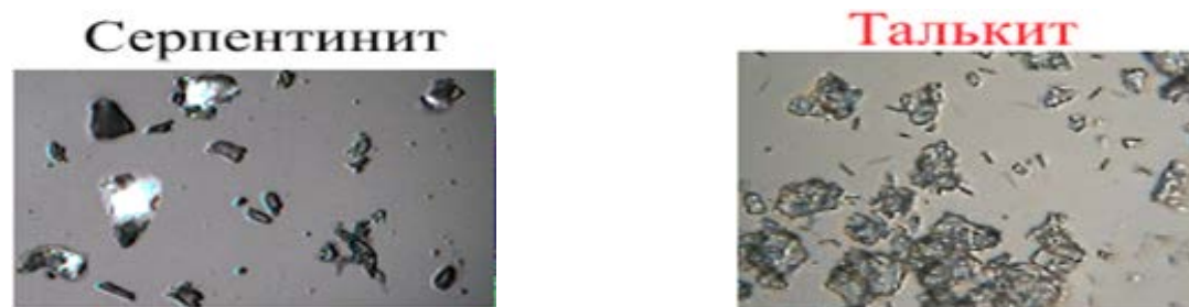
Рис. 3.7 Микрофотографии морфологических особенностей дисперсных частиц гидросиликатов магния (x400).
