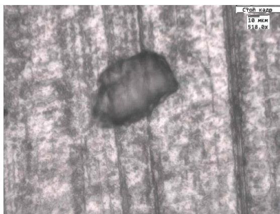
Рис. 4.2. Стекловидное тело, обнаруженное на поверхности трения роликового подшипника
