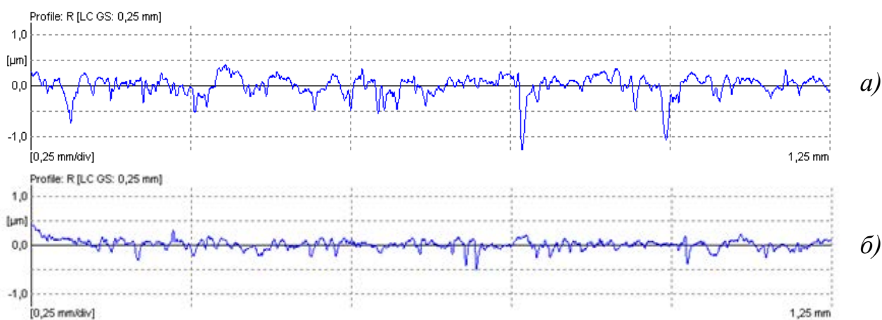
Рис. 3.11 Характерные профилограммы до (а) и после (б) испытания КСМ с дисперсными частицами гидросиликата магния
