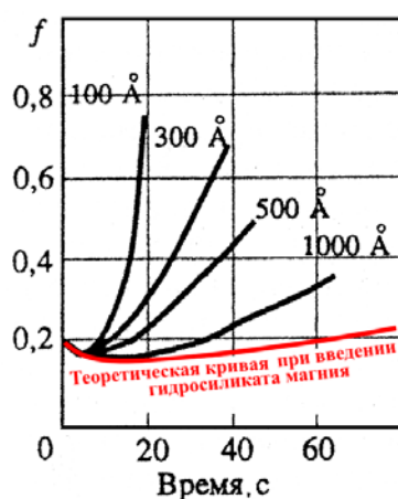
Рис.4.13 Долговечность граничных слоев разной толщины при трении (по Б.В. Дерягину)
