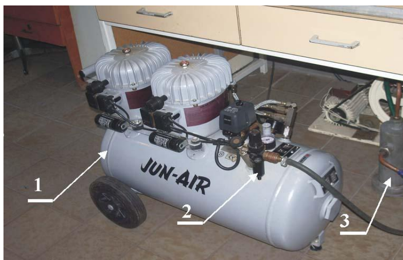
Рисунок 2.21 - Воздушный компрессор: 1 – воздушный компрессор «Jun-Air»; 2 – фильтр грубой очистки; 3 – фильтр тонкой очистки
