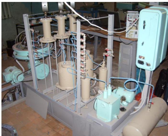
Рисунок 2.9 - Оборудование для изучения коррозионно-механических процессов в узлах трения в присутствии агрессивной газовой среды:
