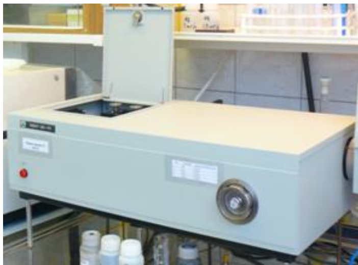
Рисунок 2.26 - Концентратор определяемого элемента в пробе «Квант-2А-ГРГ»
