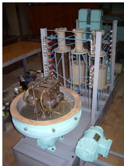
Рисунок 2.9 - Оборудование для изучения коррозионно-механических процессов в узлах трения в присутствии агрессивной газовой среды:
