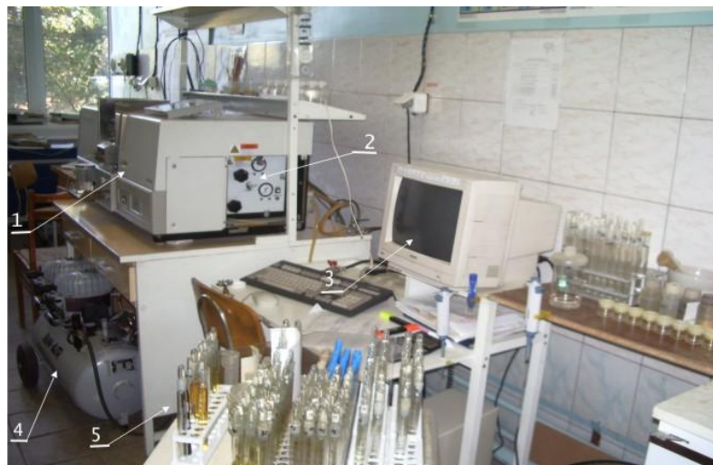
Рисунок 2.20 - Атомно-абсорбционный спектрометр (пламенник) «Shimadzu AA-6601 F»: 1 - ААС «Shimadzu»; 2 - газораспределительный узел; 3 - управляющий компьютер; 4 - компрессор; 5 - проба
