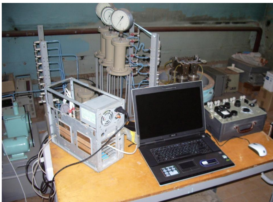
Рисунок 2.12 - Пульт управления оборудованием при испытании в различных коррозионных средах и для записи диаграмм сил трения при условиях, моделирующих рабочие процессы
